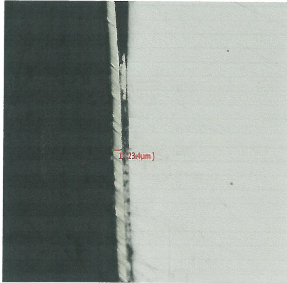
圖(4)電鍍後表面不良樣品 金相橫切面 100X
