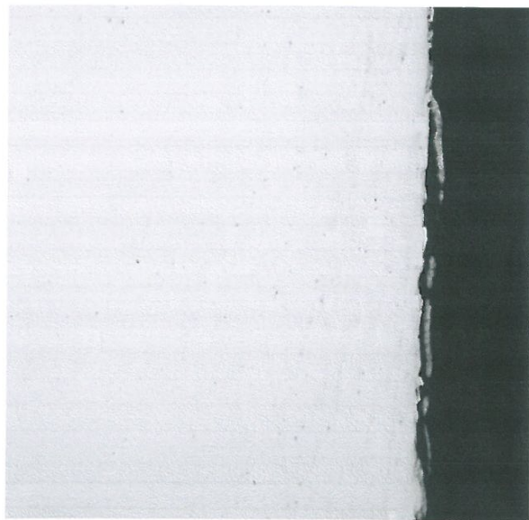
圖(6)熱處理後表面不良樣品 金相橫切面 200X
